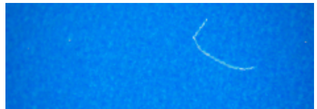
圖 4-16 青色滿版色塊顯微照，白色絲為瑕疵部份 (X-Loupe G20 150X 拍攝)
