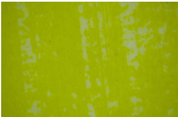
圖 3-2 未乾印刷半成品耐磨擦測試後的顯微照( X-Loupe G20 150X 拍攝)
