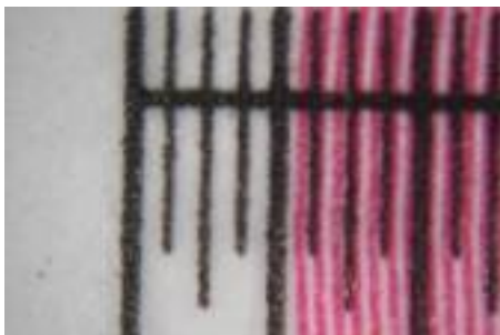
圖 4-14 微量尺與洋紅色線顯微照 (X-Loupe G20 150X)
