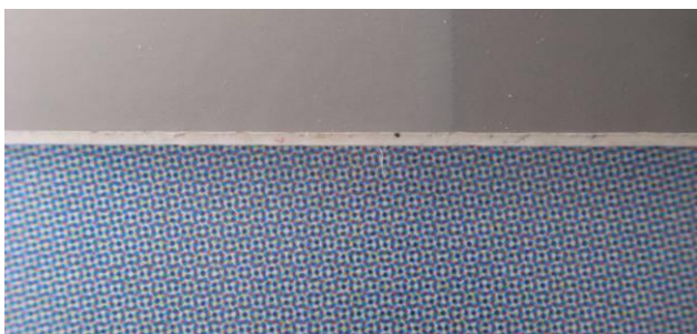
圖 4-4 印刷品灰色比對 (X-Loupe G20 150X 拍攝)
